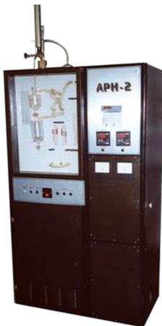
Рисунок 5 - Апарат ректифікації нафти АРН-2
