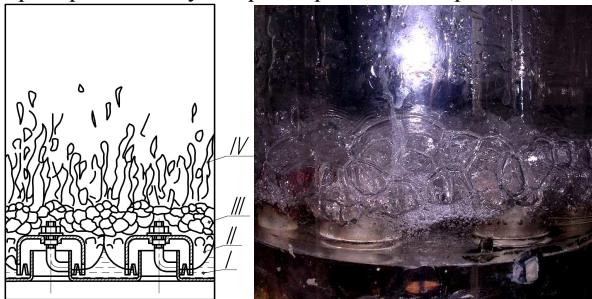
Рисунок 8.14 – Схема барботажу на ковпачковій тарілці
