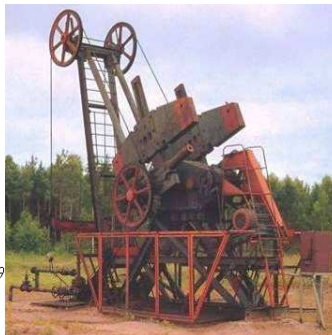
Рисунок 2.21 – Безбалансирний ПШСН з кривошипно-шківним перетворювальним механізмом:
