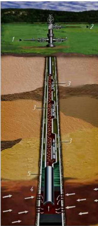
Рисунок 2.15 – Схема газліфта із зануреними клапанами і пакером:
