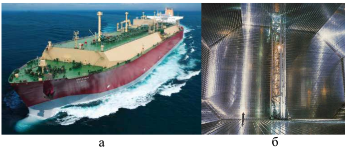
Рисунок 3.8 – Танкер мембранного типу «Mozah» (а); вигляд зсередини (б)
