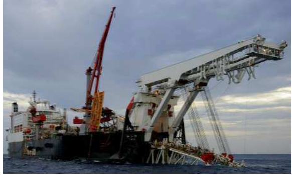
Рисунок 3.23 – Найбільше у світі судно «Solitaire» для прокладання морського трубопроводу
