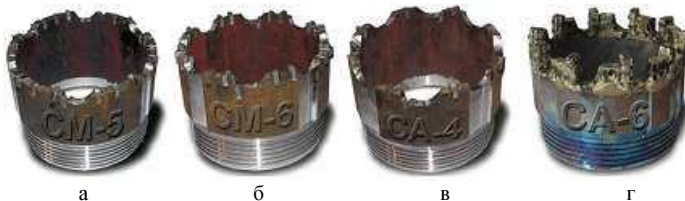
Рисунок 1.27 – Загальний вигляд твердосплавних коронок: а – тип СМ5; б – тип СМ6; в – тип СА4; г – тип СА6
