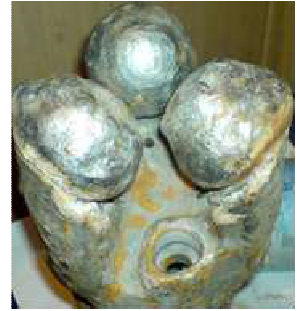
Рисунок 1.22 – Зношене долото (унікальний випадок)
