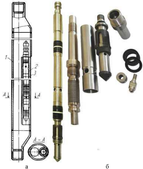
Рисунок 2.16 – Газліфтовий клапан: а – клапан, установлений у підіймальних трубах; б – клапан, його вузли і деталі; 1 – камера свердловини; 2 – посадочне гніздо; 3 – занурений клапан;
