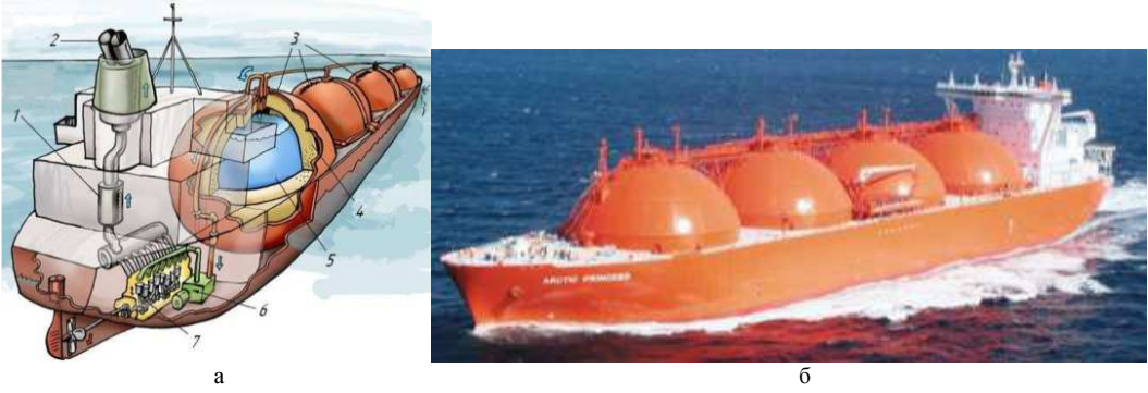
Рисунок 3.7 – Сферичний танк типу «MOSS»:
