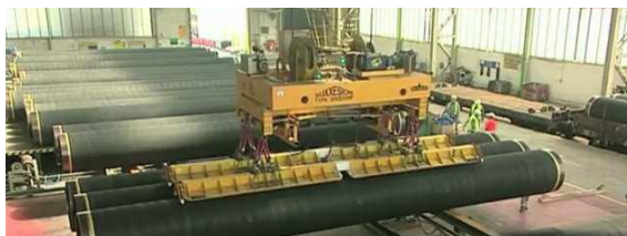
Рисунок 3.21 – Підготовка труб на спеціалізованому заводі
