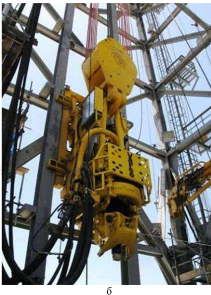
Рисунок 1.5 – Система верхнього привода:
