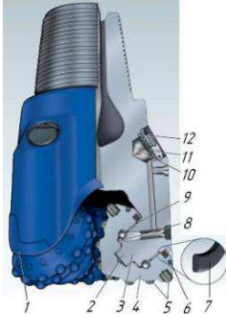
Рисунок 1.19 – Схема тришарошкового долота з герметизованою опорою: 1 – твердосплавний захист калібру; 2 – фрикційна цапфа; 3 – опора; 4 – шарошка; 5 – вставки з карбїду вольфраму; 6 – калїбрувальний вїнець; 7 – радіальний сальник з еластомером; 8 – опорна поверхня; 9 – берилій-мїдна плаваюча втулка з срібним покриттям; 10 – камера для мастила; 11 – кришка камери для мастила; 12 – діафрагма
